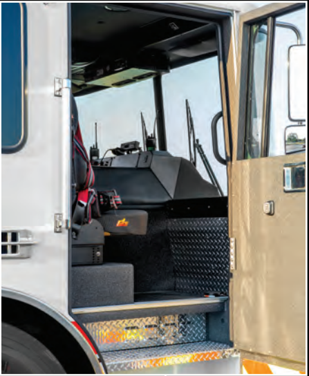
EXTERIOR DOOR HINGES ENABLE 90° DOOR OPENING
